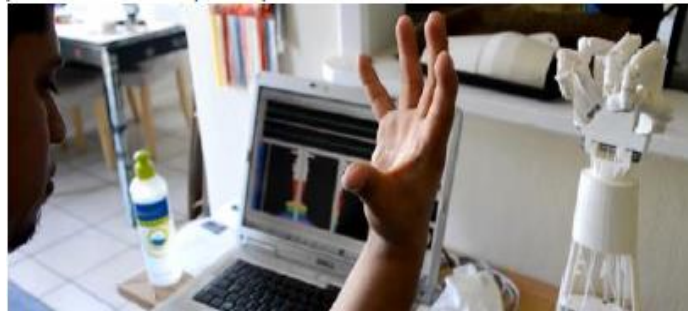
Figura 16. Mano robótica controlada por señales EMG.
