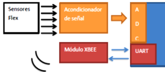
Figura 2. Diagrama de bloques del diseño del guante electrónico.
