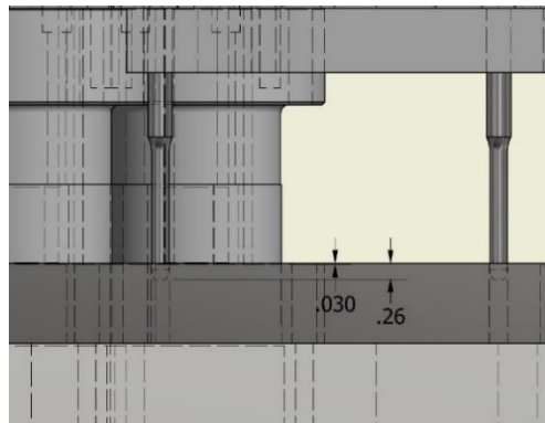
Figura 1.5 Altura de punzones y pilotos cuando el punzón de piloto (perforador) hace presión completa.
